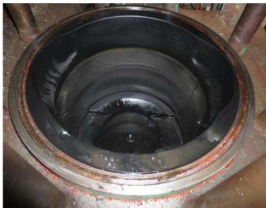
Hình 2. Piston và xi lanh số 1 của động cơ được tháo ra kiểm tra trước và sau khi chạy PO
