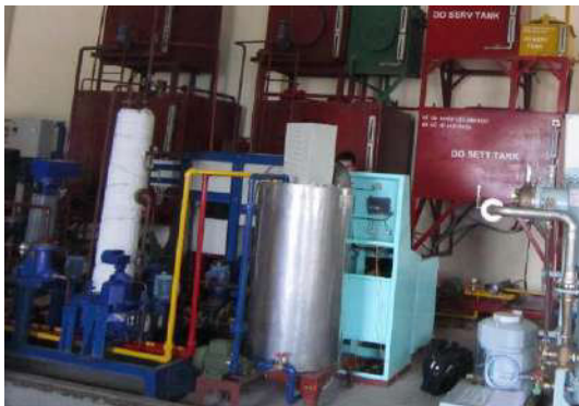
Hình 2. Bộ khuấy trộn và tủ bảng điều khiển tự động của thiết bị trộn
