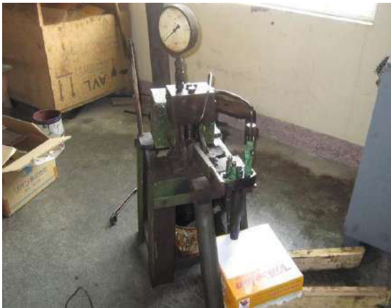
Hình 13. Băng thử vòi phun trong phòng thí nghiệm hệ động lực
