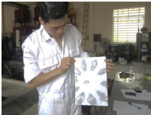
Hình 3. Kiểm tra chất lượng phun trên bộ thử và đo lưu lượng phun
