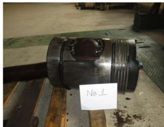
Hình 2. Piston và xi lanh số 1 của động cơ được tháo ra kiểm tra trước và sau khi chạy PO
