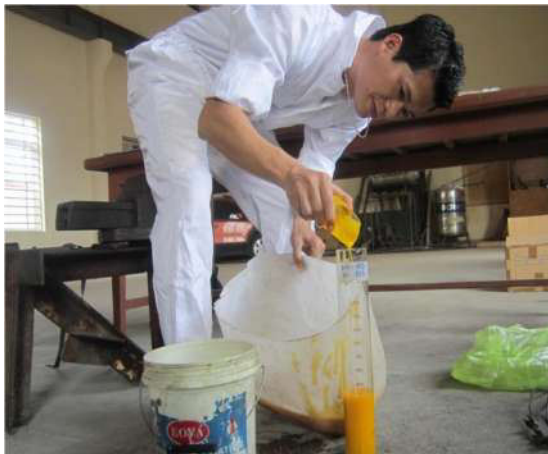
Hình 7. Kiểm tra trực quan chất lượng dầu cò
