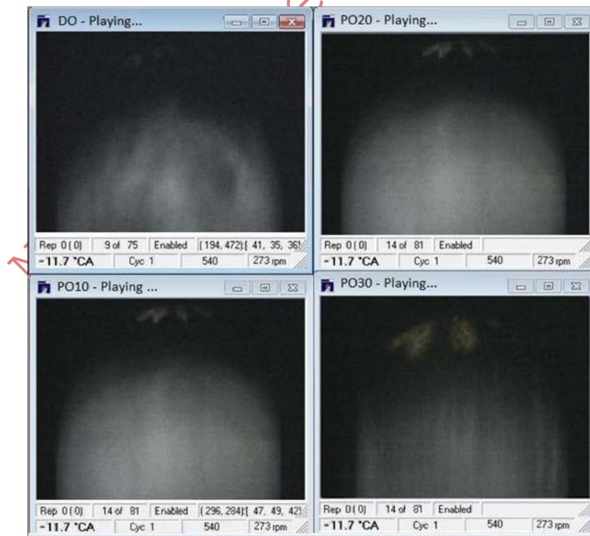
Hình 4.11. Hình ảnh nhiên liệu bắt đầu phun ở -11,7 độ GQTK trước ĐCT, 273 v/p
