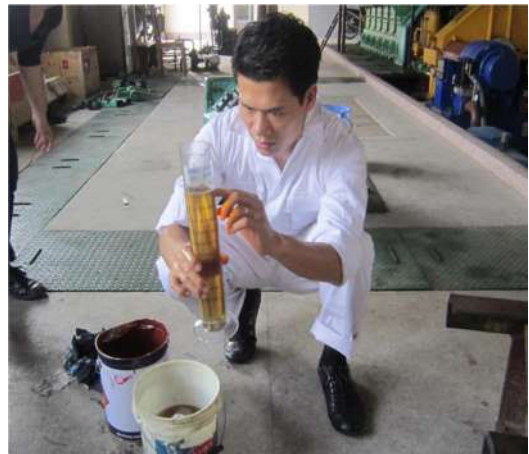
Hình 7. Kiểm tra trực quan chất lượng dầu cò
