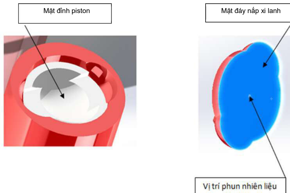
Hình 3.19. Hình dạng không gian buồng đốt động cơ diesel 6LU32 trong AutoCAD Mechanical 2017
