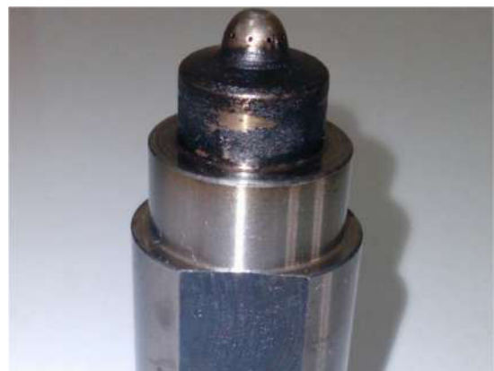
Hình 8. Tình trạng đầu vòi phun động cơ 6LU32 sau khi chạy thử các loại hỗn hợp nhiên liệu
