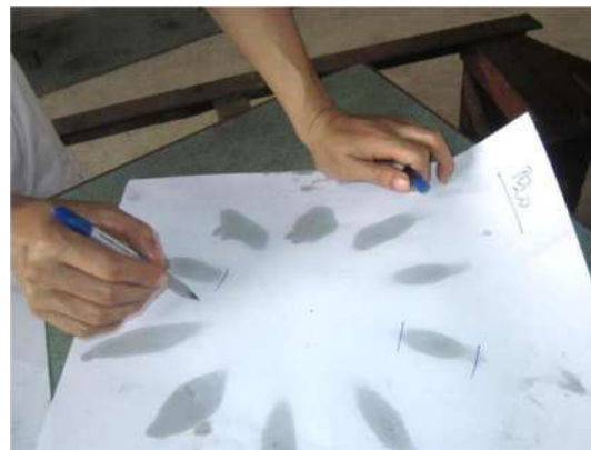
Hình 3. Kiểm tra chất lượng phun trên bộ thử và đo lưu lượng phun
