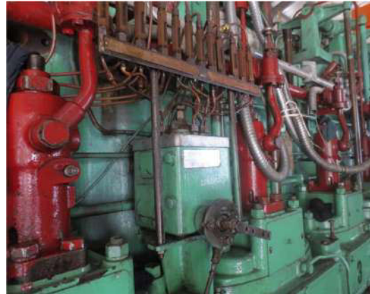
Hình 1. Hệ thống cấp nhiên liệu cho động cơ Hanshin 6LU32
