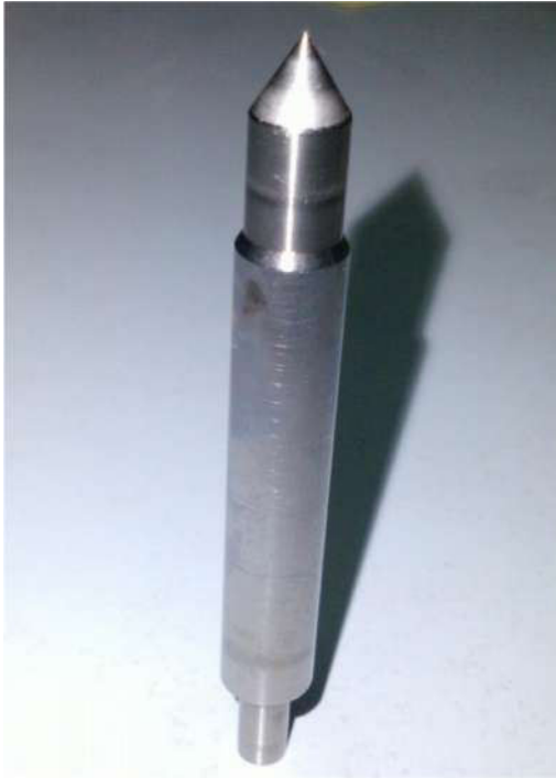
Hình 4. Tình trạng vòi phun nhiên liệu động cơ 6LU32 trước khi chạy thử
