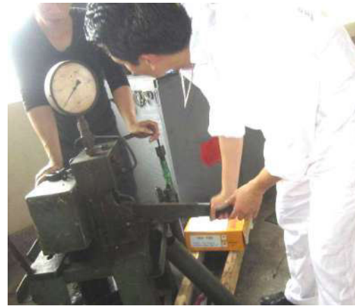
Hình 13. Băng thử vòi phun trong phòng thí nghiệm hệ động lực
