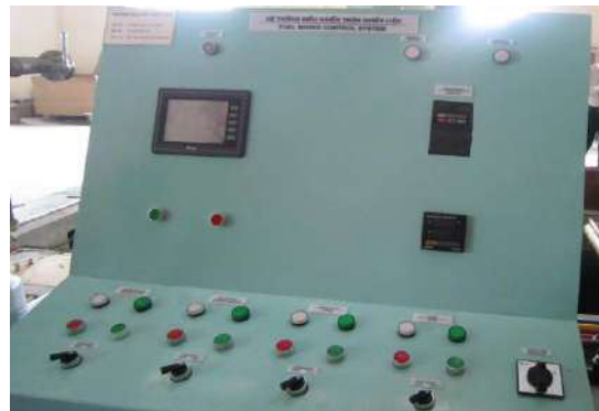
Hình 2. Bộ khuấy trộn và tủ bảng điều khiển tự động của thiết bị trộn
