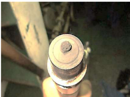
Hình 8. Tình trạng đầu vòi phun động cơ 6LU32 sau khi chạy thử các loại hỗn hợp nhiên liệu
