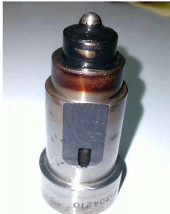
Hình 4. Tình trạng vòi phun nhiên liệu động cơ 6LU32 trước khi chạy thử
