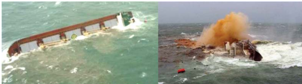
Hình 1.14: Tàu Bulk Jupiter bị nghiêng và đắm do hàng rời có tính nhão chảy
