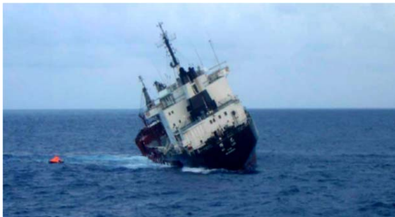
Hình 1.13: Tàu Hui Long bị nghiêng trái do hàng rời có tính nhão chảy
