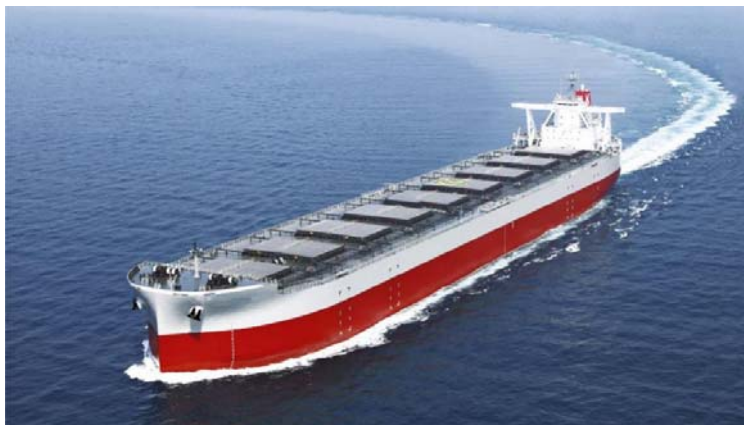
Hình 1.2: Tàu hàng rời không có thiết bị làm hàng
